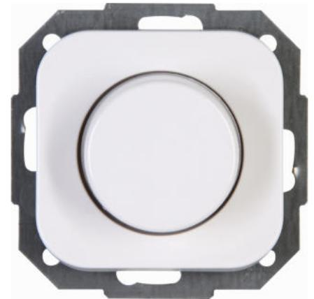
DONAU - Kombigerät - Druck-Wechselschalter, LED-Dimmer. Geeignet für Glühlampen und 230V Halogenlampen, dimmbare LED's sowie NV-Halogenlampen mit konventionellen Trafos (Bitte technische Angaben der Trafo-Hersteller beachten). Einstellbare Grundhelligkeit, mit Softrastung, Phasenanschnitt RL 20-250W/VA, LED 3-35W, 230 V~, 50Hz, Farbe: arktisweiß
