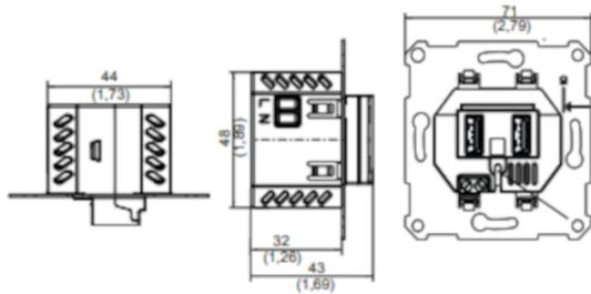
Alle Abmessungen in Millimeter (Inch), Abweichung  $\pm 0,5$  (0.02)
